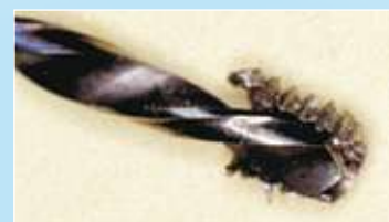
VITE ROTTA IN FASE DI RIMOZIONE
