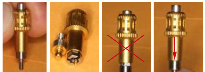
meccanismo di bloccaggio
