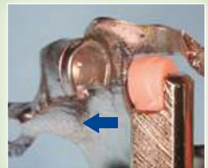
Inserzione della cappetta nel contenitore INOX in senso laterale
